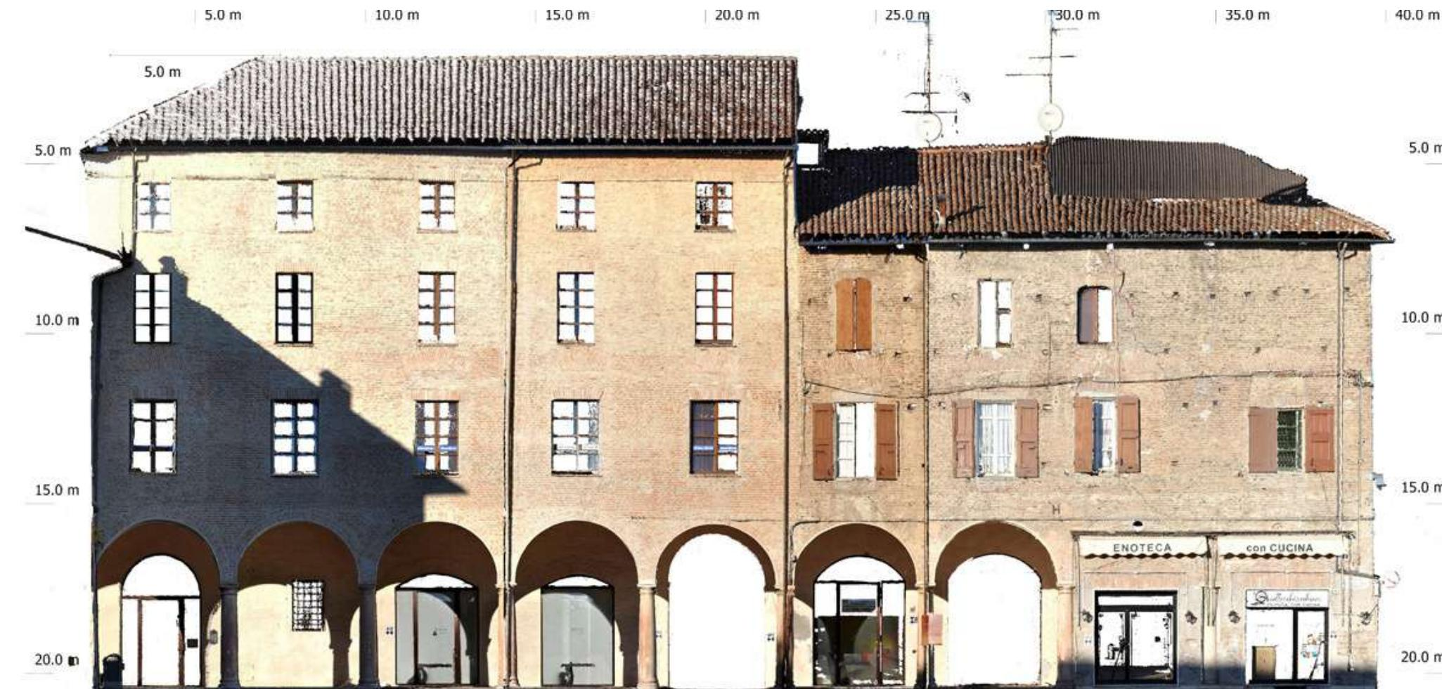
Da tali rilievi si possono ottenere tutte le caratteristiche dimensionali dell'edificio da analizzare con ottime precisioni, essendo uno studio tecnico di progettazione e topografia siamo in grado di considerare ogni aspetto del rilievo e di computare e progettare interventi successivi e seguire i cantieri in ogni fase
